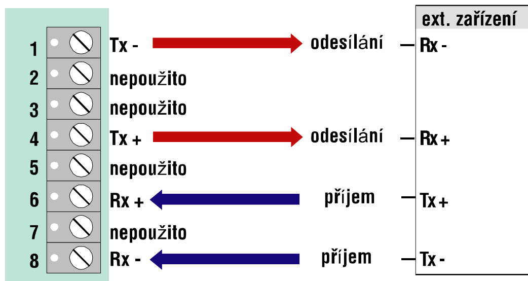
Obr. 78: Technologie zapojení rozhraní TTY
