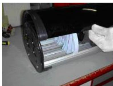
Posizionare coperchio inferiore sopra la base, inserire la colonna nell'apposita spina dopo aver posizionato la staffa a L di bloccaggio e fissare il tutto utilizzando le viti in dotazione.
