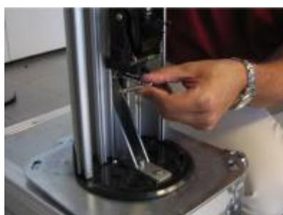
Nella parte superiore di ciascuna colonna sono presenti due interruttori (tamper) in serie. Quello laterale segnala la rimozione del coperchio superiore. Quello centrale segnala invece la pressione sul coperchio ed è quindi indicato per rivelare tentativi di scavalcamento.
